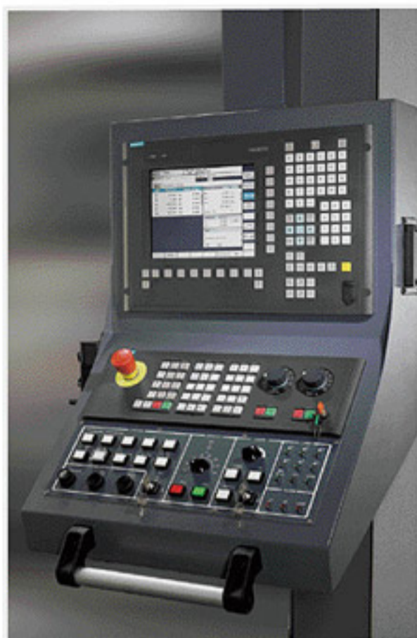
• SIEMENS 840D Control Type
